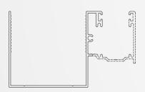
Guida in alluminio estruso 85 x 51,20 in barre da 6,5 metri
